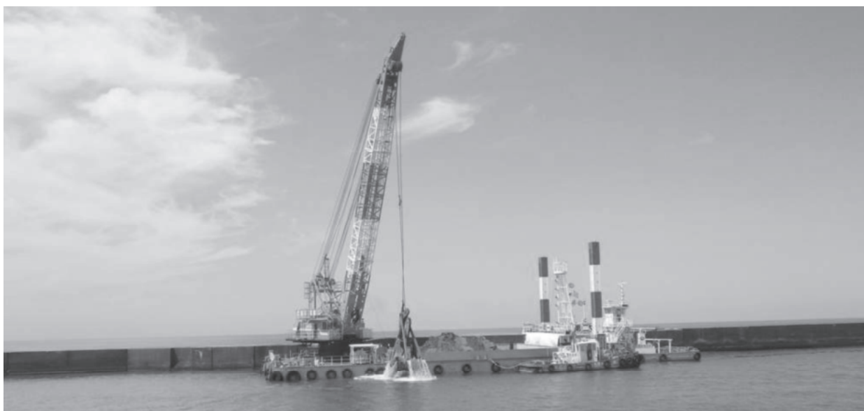
リプレースした 120t 吊起重機船
